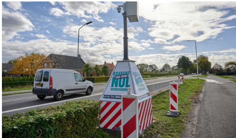
Verplaatsbare flitspaal achter tijdelijke vangrails (foto © Tom van der Put, internetbode)
